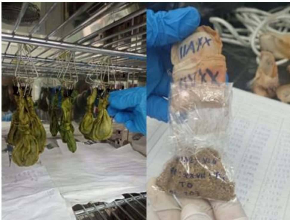
Foto 4: Secado de muestras para registro de datos de la materia seca
