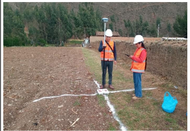
Marcado de BM-03 con yeso para su fácil identificación con el dron durante el vuelo.
