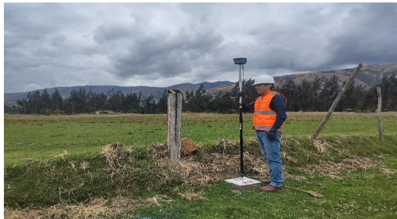
Fotografía 22: Captura de coordenadas UTM de cada BM, con receptor GNSS diferencial móvil conectada a una Tablet.
