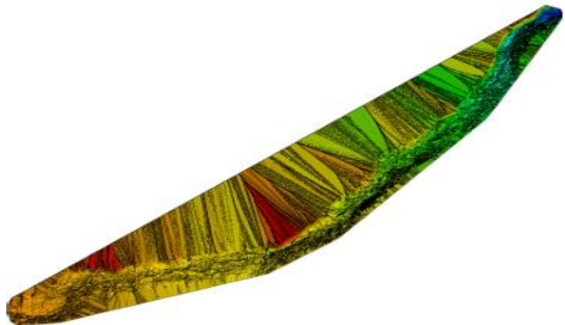
Figura 45: MDE del tramo de estudio obtenida del levantamiento topográfico con Dron RTK.
