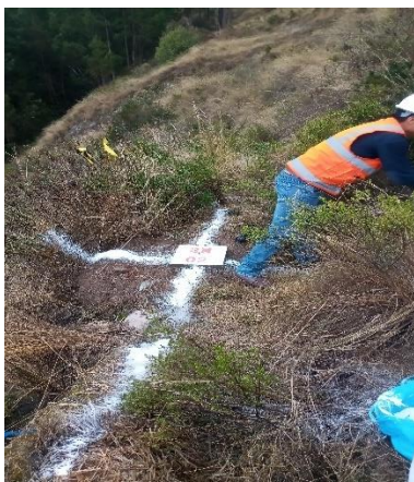
Marcado de BM-02 con yeso para su fácil identificación con el dron durante el vuelo.
