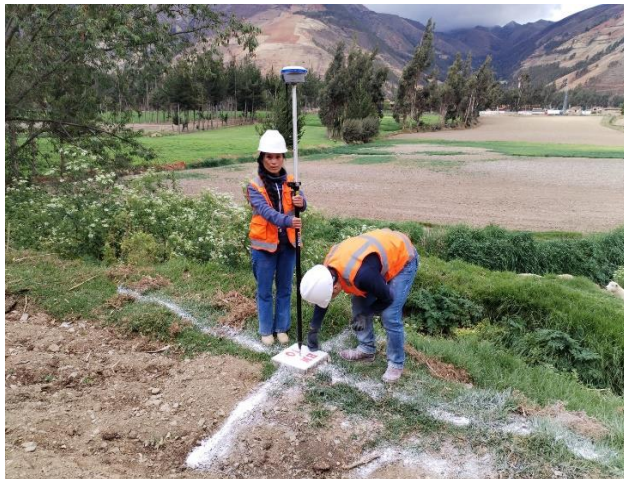
Marcado de BM-10 con yeso para su fácil identificación con el dron durante el vuelo.
