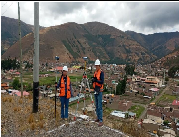
Inicio de captura de coordenadas y altitud de cada BM con receptores GNSS (uno Estacionado y uno Móvil).
