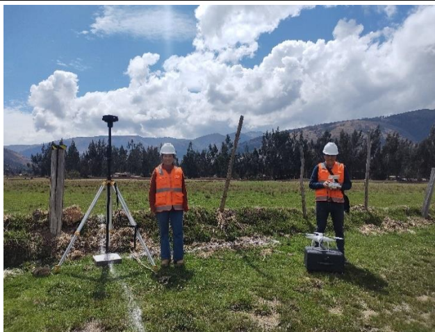
Vuelo-01: Despegue desde BM-21, con cobertura del área aguas arriba del río Opamayo.
