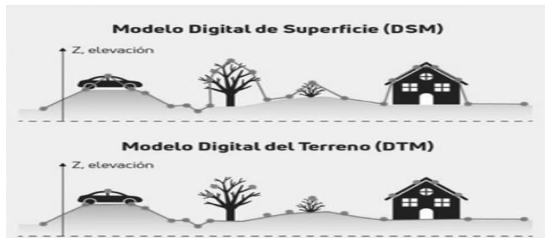
Figura 13: Diferencia entre un DSM y MDE/MDT.
