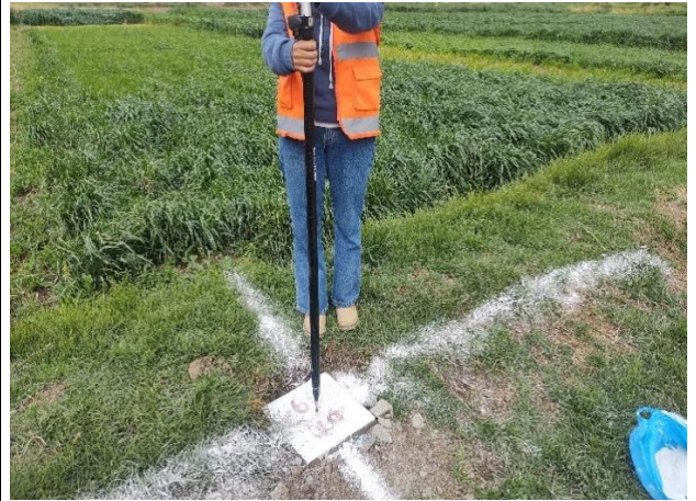
Marcado de BM-09 con yeso para su fácil identificación con el dron durante el vuelo.
