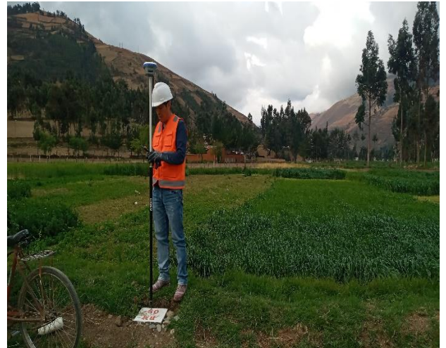
BM-09: Coordenadas UTM (E: 515306.457; N: 8631553.55), cota altimétrica: 3219.323 m s.n.m
