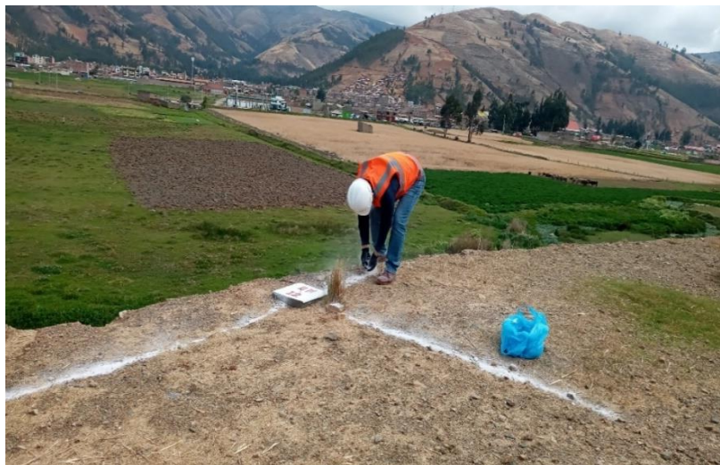
Fotografía 24: Tesista remarcando los BMs desde 01 al 22 con yeso para su fácil identificación con el Dron.
