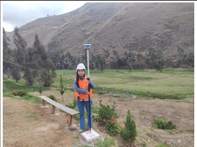
BM-01: Coordenadas UTM (E: 517684.988; N: 8634287.840), cota altimétrica: 3195.946 m s.n.m.
