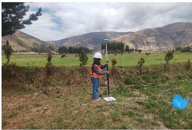
BM-16: Coordenadas UTM (E: 512708.312; N: 8629664.05), cota altimétrica: 3242.176 m s.n.m
