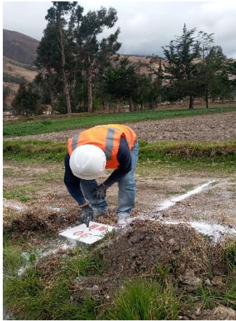
Marcado de BM-06 con yeso para su fácil identificación con el dron durante el vuelo.
