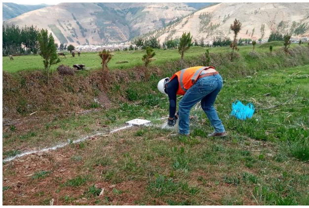
Marcado de BM-16 con yeso para su fácil identificación con el dron durante el vuelo.
