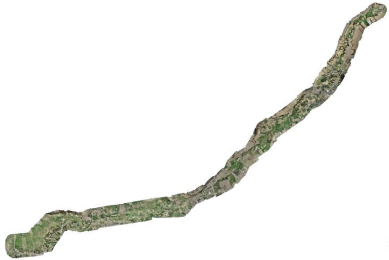
Figura 44: Ortofoto del tramo de estudio obtenida del levantamiento topográfico con Dron RTK.
