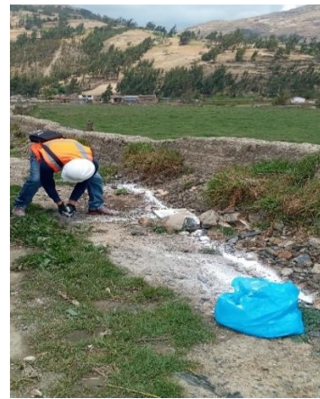
Marcado de BM-22 con yeso para su fácil identificación con el dron durante el vuelo. Una vez terminado el marcado de los 22 BMs se procedió a la ejecución de los vuelos.
