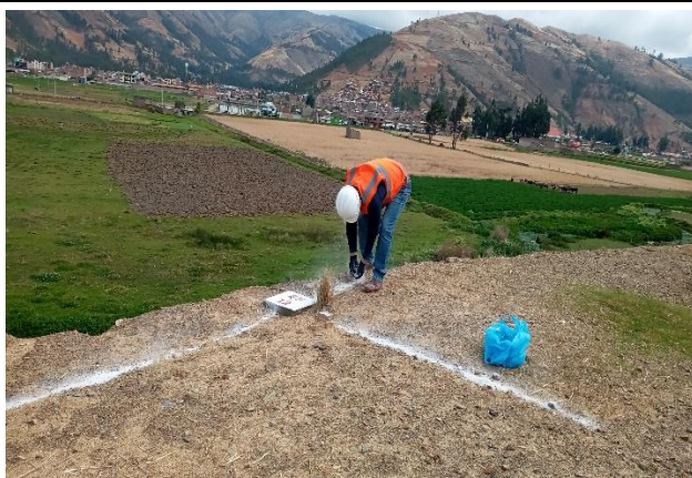
Marcado de BM-12 con yeso para su fácil identificación con el dron durante el vuelo.
