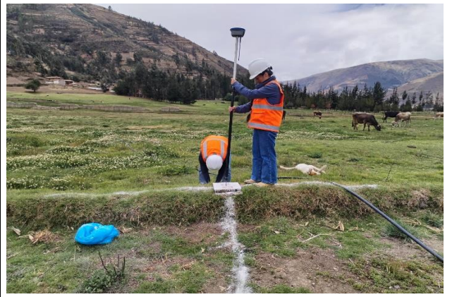
Marcado de BM-18 con yeso para su fácil identificación con el dron durante el vuelo.
