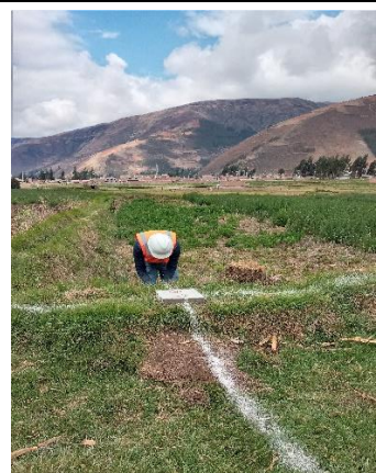
Marcado de BM-15 con yeso para su fácil identificación con el dron durante el vuelo.
