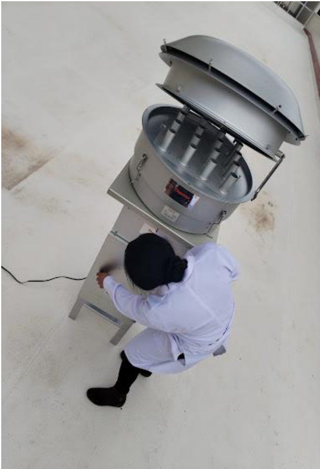
Fotografía 5. Puesta en marcha del muestreador de alto volumen (Hi-Vol) para la obtención de muestras de material particulado representativas
