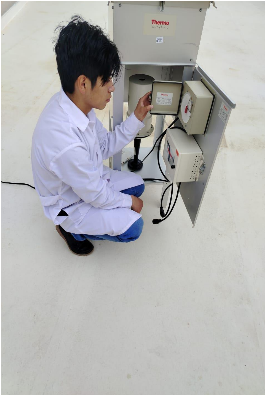
Fotografía 3. Programación en el panel de control del muestreador Hi-Vol para el monitoreo atmosférico
