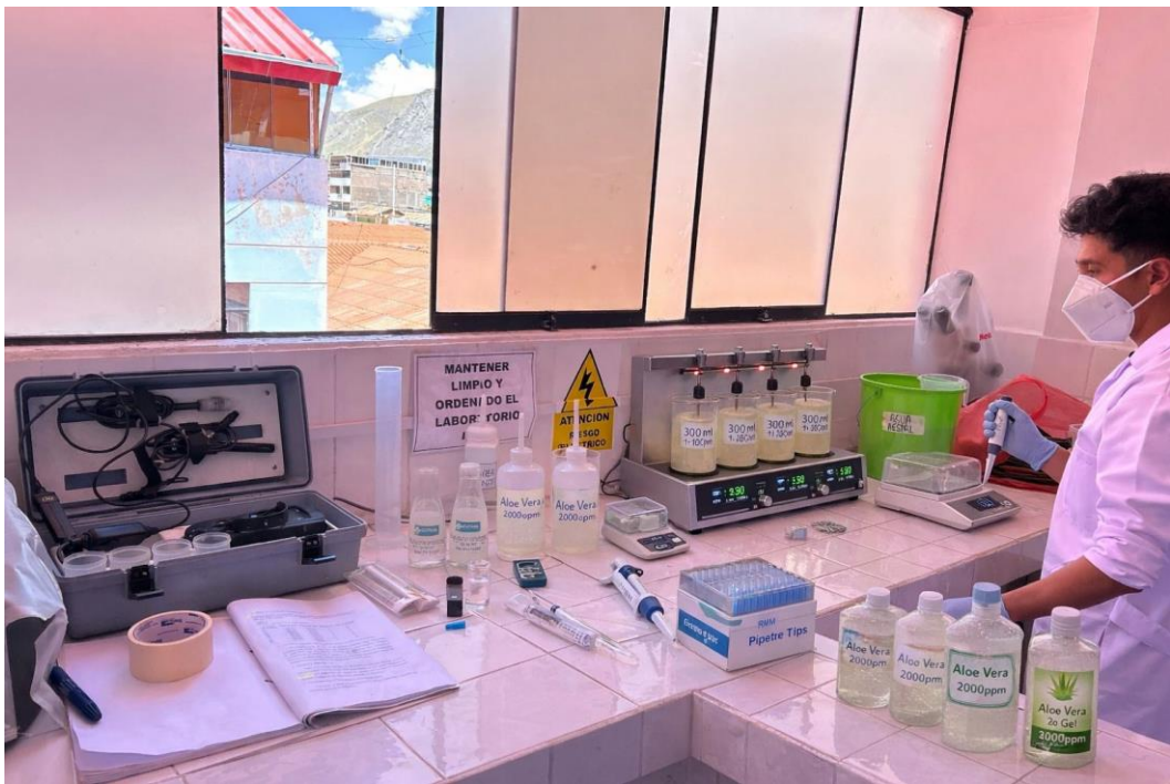
Figure 6. Parámetros de operación de equipo de jarras.
