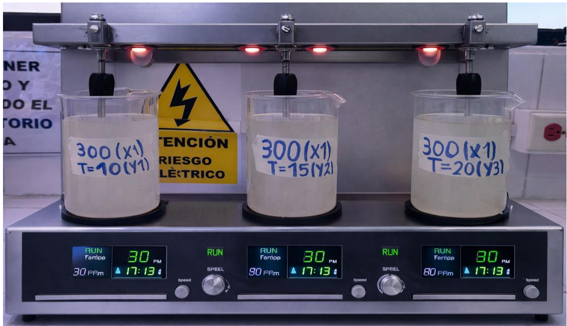
Figure 7. Etapas de agitación rápida y lenta para X1 300
